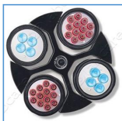
Figura 02 – Colocação balanceada de tubos na centrífuga
